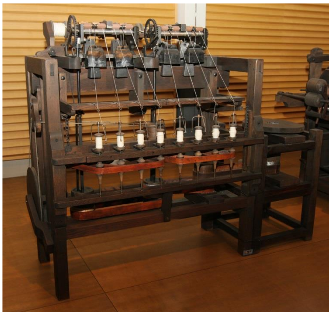
Slika 3: Mehanička predilica Richarda Arkwrighta iz 1769. (replika). Ovaj stroj je jedan od ključnih izuma u tekstilnoj industriji koji su omogućili strahovito podizanje produktivnosti, pa se moglo prijeći na masovnu tvorničku proizvodnju, što je polako gasilo potrebe za seljačkom kućnom radinošću u proizvodnji i preradi tekstila. Sve veći ovakvi i slični strojevi bili su i veličinom i cijenom neprikladni za kućne poslove, zato se za brojne takve strojeve počelo graditi proizvodne hale, koje će postati svakodnevica industrijskog doba, a tekstilna industrija bila je prva koja je krenula u pravom industrijskom smjeru.
